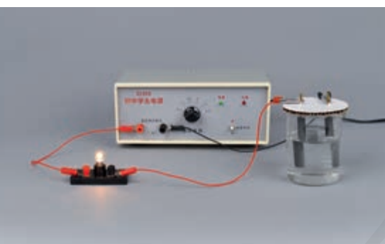
图1-9 试验物质的导电性
